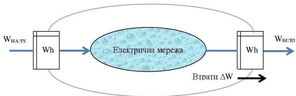
Рис. 1.2 - Баланс електроенергії в електричних мережах
